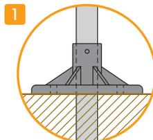
1 地中に埋設したパイプに連結して沈下・横ズレ防止
