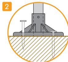
2 固定用穴に釘を打込んで沈下・横ズレ防止
